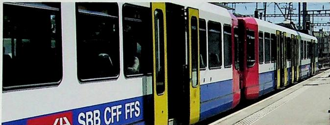
Les trains qui circulent sur la ligne Genève – Bellegarde depuis la fin des années 90 (Bern) ont été complètement révisés en 2009: roulements, installations de sécurité, systèmes pneumatique, électrique et de freinage. L'intérieur et l'extérieur des véhicules ont été rafraîchis. Ils offrent maintenant un excellent niveau de disponibilité et les pannes que vous avez peut-être subies par le passé ne devraient plus se produire.
