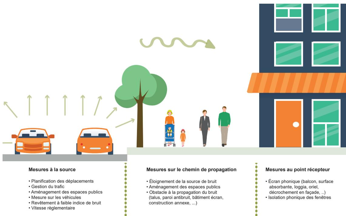
La mesure la plus efficace pour la lutte contre le bruit routier consiste aujourd'hui en la pose d'un revêtement bitumineux phono-absorbant. Cette mesure est retenue de manière quasi-systématique dans les projets d'assainissement du bruit routier.
